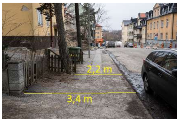
Figur 12: Svandammsvägen 29 – 33 där den hinderfria bredden är 2,2 m bredd och den totala bredden 3,4 m. På motsatt sida av gatan varierar bredden mellan 1,5 och 3 meter.
