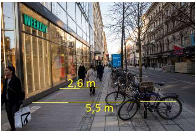
Figur 7: Kungsgatan 49 – 51 där hinderfri bredden är 2,6 m och den totala bredden är 5,5 m. På motsatt sida av gatan varierar bredden mellan 2,5 och 5,2 meter.
