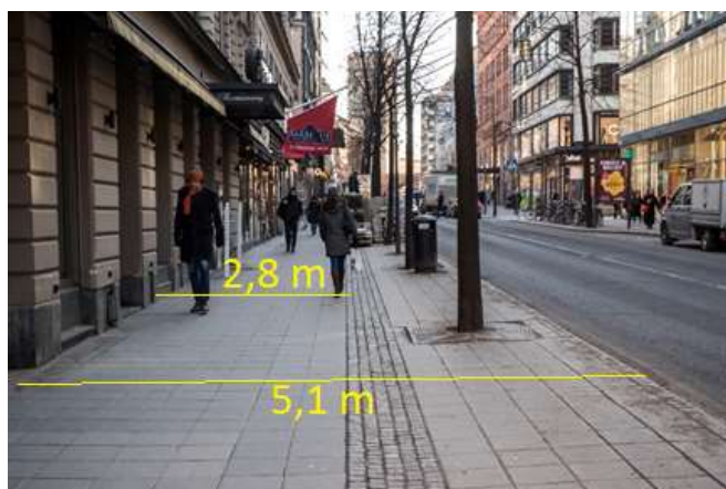
Figur 8: Kungsgatan 54 – 56 där gångbanan varierar mellan 2,8 och 5,1 m bredd. På motsatt sida av gatan varierar gångbanans bredd mellan 2,5 och 5,2 meter.
