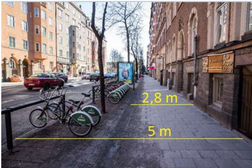
Figur 3: Flemminggatan 55 – 63 där hinderfri bredden är 2,8 m och den totala bredden 5 m. På motsatt sida av gatan varierar gångbanans bredd mellan 2,8 och 4,8 meter.
