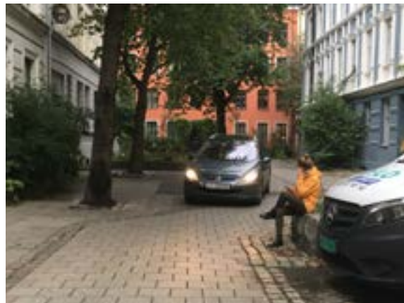
Gångfartsområde (gatutun) i Oslo. Möbleringar tvingar motorfordon att göra sidledsflyttningar. (foto Kerstin Alquist)
