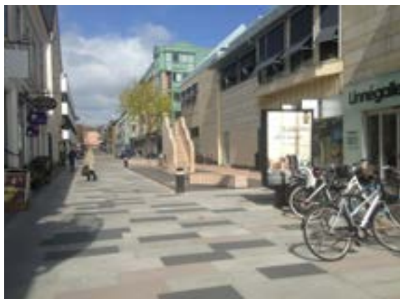
Gångfartsområde i Växjö. Skyddad zon mot den högra fasaden med hjälp av cykelparkering och lekturustning.
