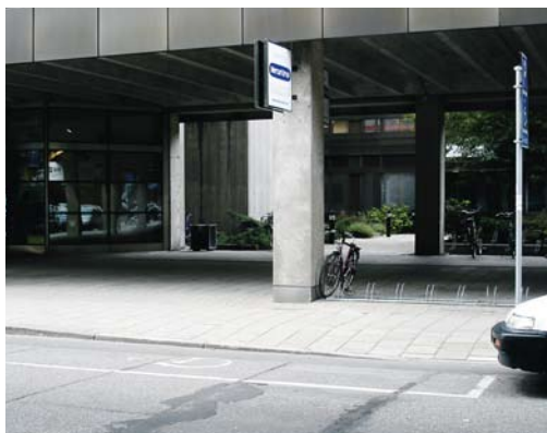
Exempel på utformning av handikapparkeringsplats placerad längs med gångbanan. (Karlavägen)
