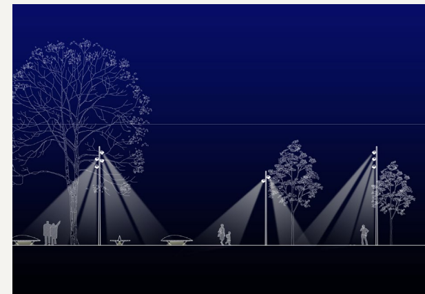
I. Platser som inte har fordonstrafik kan belysas med strålkastare på stolpe, vilket ger en mindre jämn ljusfördelning.
