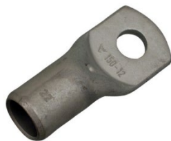
Figur 3 Kabelsko, förtent koppar med M8-hål, används till förbindning i stolpe och fundament.
